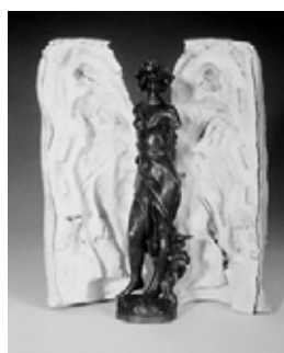
Hautformen im Streichverfahren (ELASTOSIL® M 4503 + Verdickungsadditiv M bzw. M 4601/4641 + Stabilisator 43)
