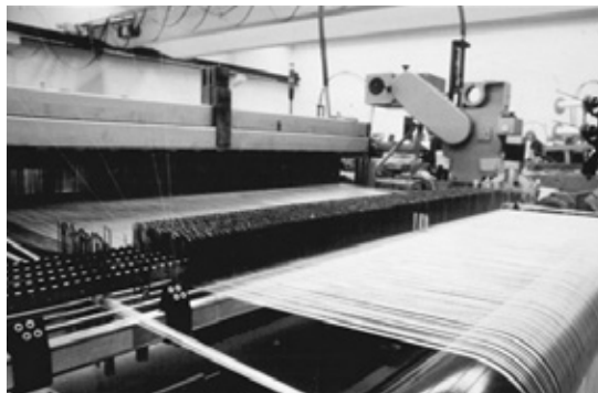
Die Kettfäden passieren an der Webmaschine den Streichbaum, die Lamellen und das Webgeschirr.
