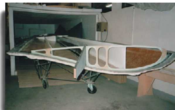
Holm und Flächenschale eines UL-Nurflüglers
