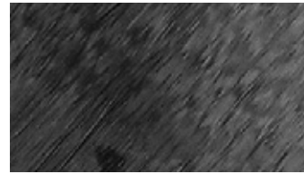
Vollkommen flach liegendes Kohle-Biaxial-Gelege Biaxial carbon inlay lying perfectly flat.
