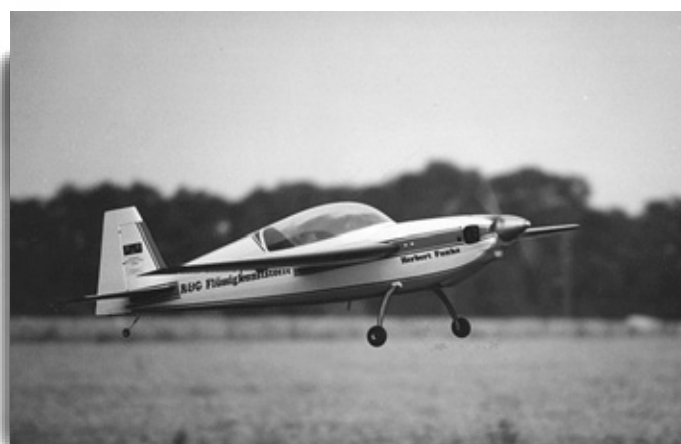
Das F3A-X Kunstflugmodell ist komplett in Wabensandwichbauweise aufgebaut. Mit Deckschichten aus 49 g/m 2 -Glasgewebe und einem 2 mm Wabenkern wird eine hohe Steifigkeit bei geringstem Gewicht erzielt.
