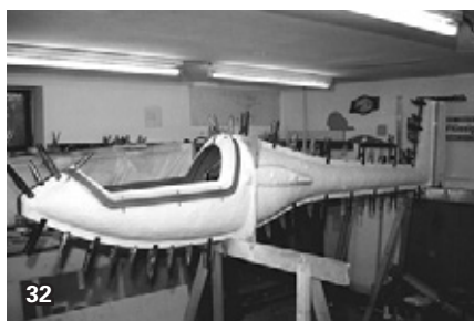
Klammern pressen die geschlossene Form zusammen.
