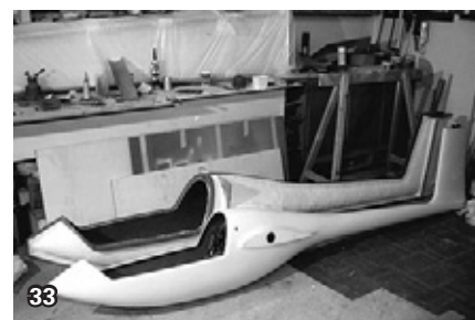
Nach 24h Härtung wird der Rumpf entformt. Das Gesamtgewicht beträgt 8,5 kg, davon abzuziehen sind 4,5 kg für das Klapptriebwerk und 1,5 kg für Einziehfahrwerk und Spant. Es bleibt ein Schalentgewicht von 2,5 kg für einen Rumpf mit ca. 2,5 m 2 Fläche.
