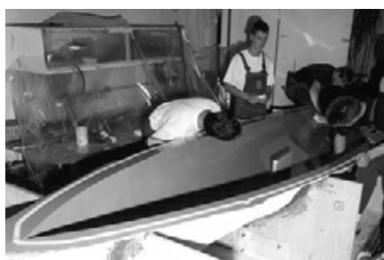
Negativ-Form aus Epoxydharz/Laminierkeramik
