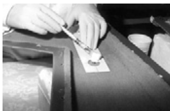
Aufbringen gefüllter Harze mit Pinsel/Spritztüte
