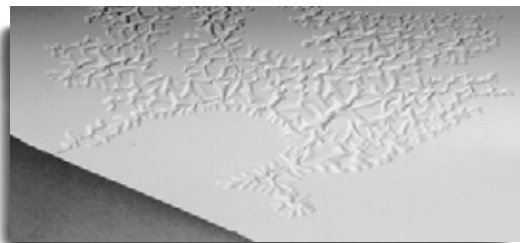
Elefantenhaut in einer Polyesterdeckschicht.
